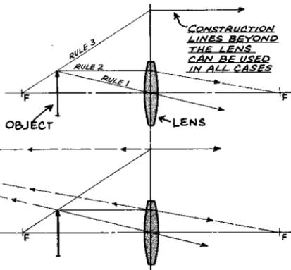
**⑪ BACKWARD EXTENSION OF THE RAYS WILL INTERSECT TO LOCATE THE IMAGE WHICH IS VIRTUAL**
