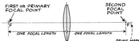
THE FOCAL LENGTH OF A LENS IS THE SAME IN EITHER DIRECTION
